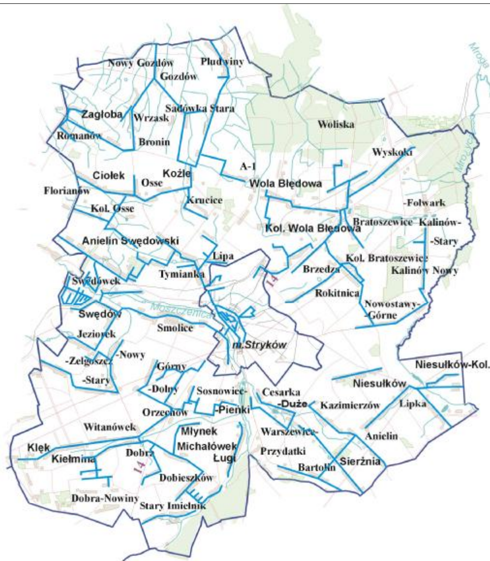
Rys. 4 Rozmieszczenie sieci wodociągowej w Gminie Mieście Stryków
